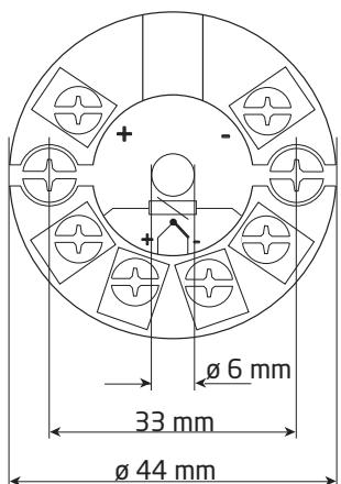
**Монтаж кабеля датчика**
